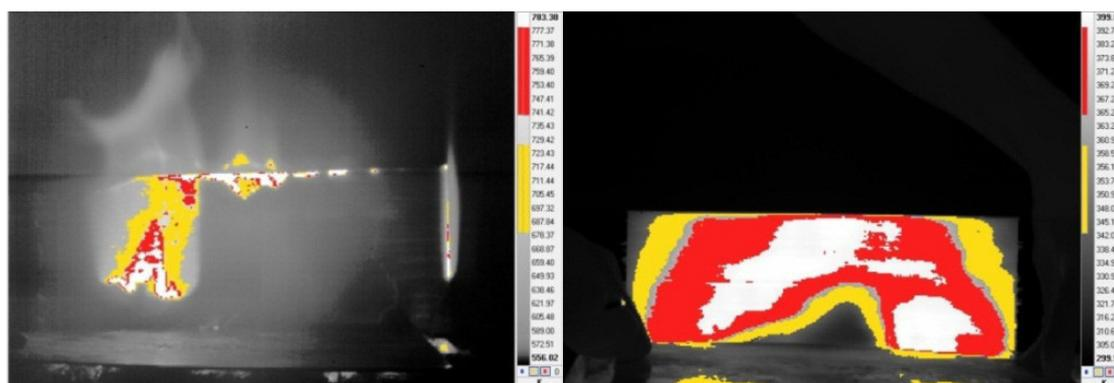
Рис. 1. Термограмма образца блок-хауса
