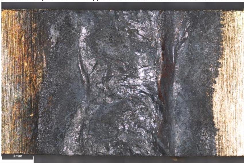
Рисунок 1. Область отрыва покрытия от подложки
