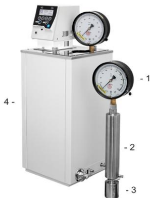
Рис. 9. Схема аппарата для определения давления насыщенных паров нефти и нефтепродуктов
