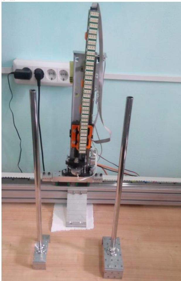
Рис. 3 – Внешний вид матрицы из 16 МД и два тесовых объекта в виде металлических трубок
