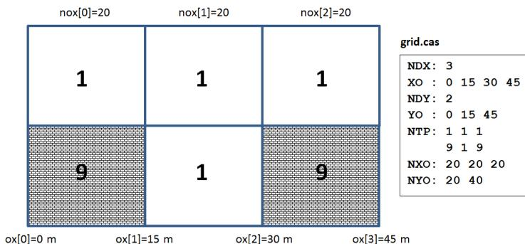
Рис. 2. Разделение области исследования на подобласти и пример содержания файла grid.cas для рассматриваемой области
