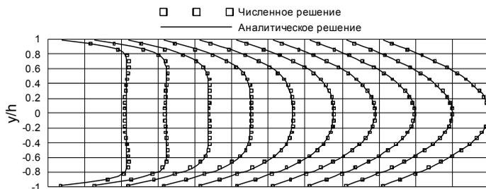
Рис. 3. Распределение осевой скорости при аналитическом и численном решении в различных сечениях канала
