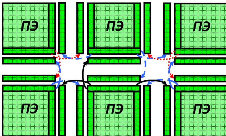
Рис. 4. Иллюстрация организации пересылок граничных сеточных значений при 2D-декомпозиции для обеспечения однородности вычислительного процесса
