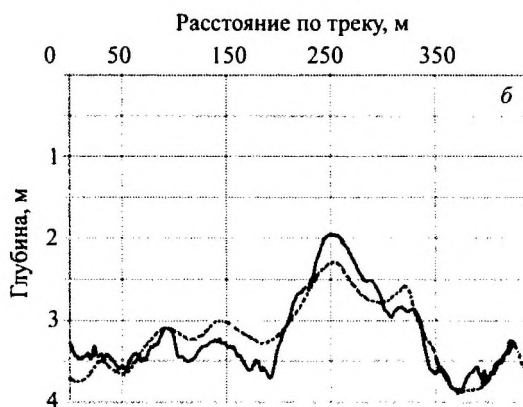
Рис. 1. Радарный профиль трассы зондирования болота ( а ) и профиль торфяного дна по радарным и контактным измерениям (пунктир) ( б )
