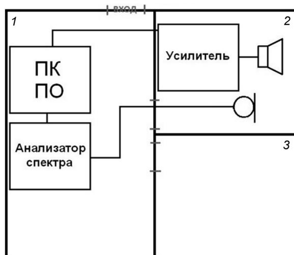
Рис. 1. Схема размещения измерительной аппаратуры
