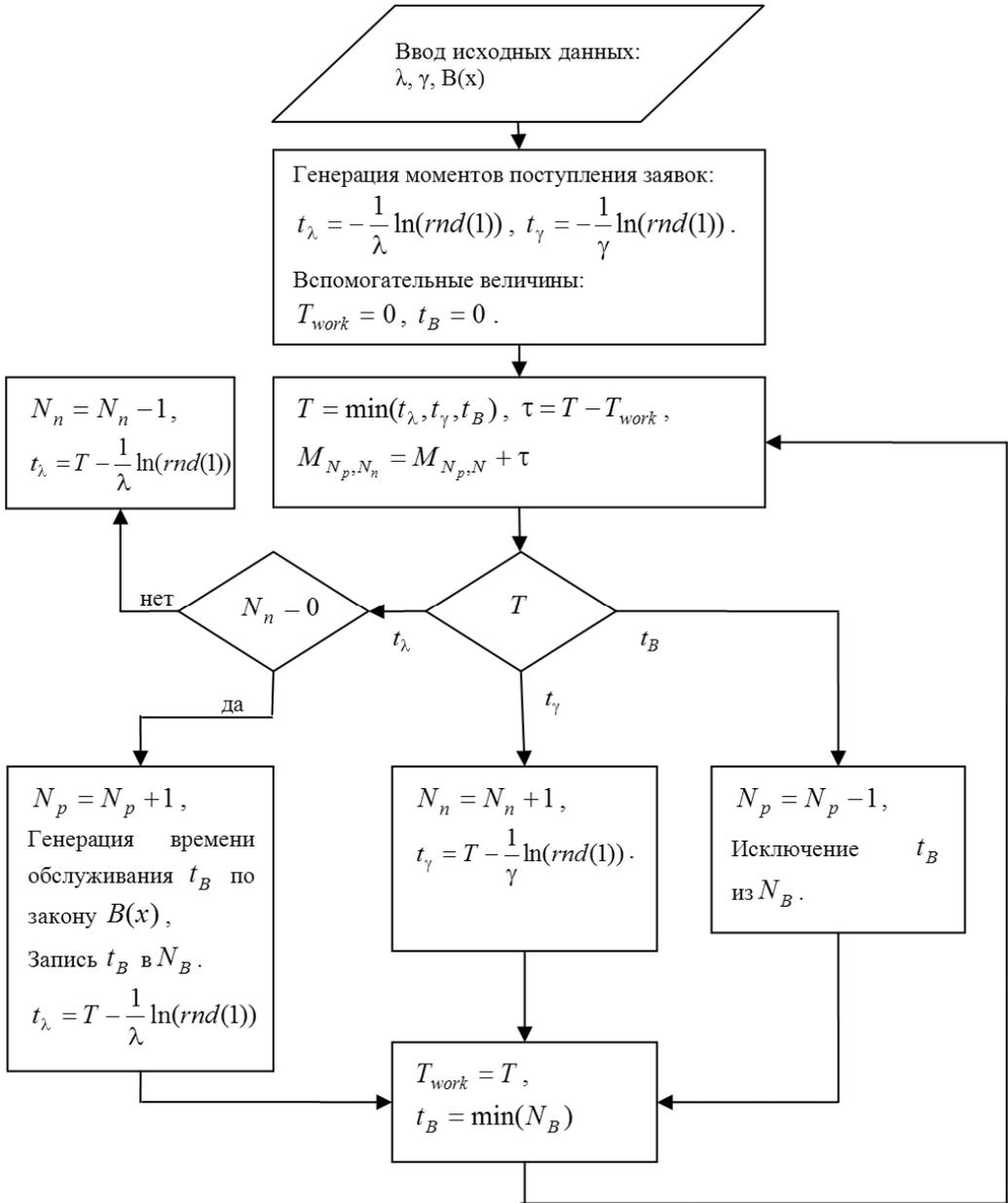
Рис. 2. Блок-схема системы обслуживания с отрицательными заявками и их ожиданием
