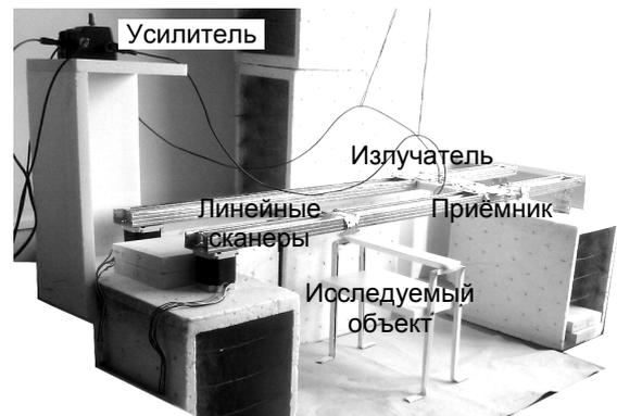
Рис. 4. Фотография экспериментальной установки и тестового объекта
