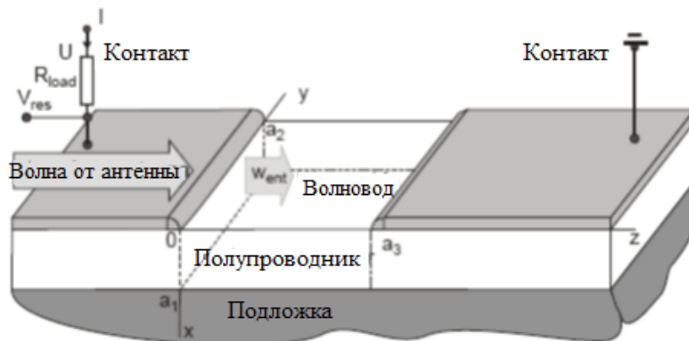
Рис. 1. Конфигурация болометра на КРТ
