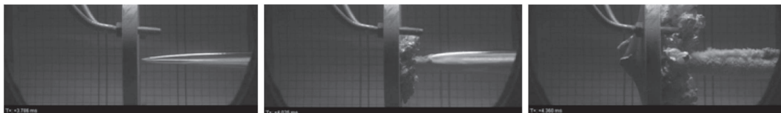
Рис. 5. Фоторегистрограмма взаимодействия суперкавитирующего реактивного снаряда в воде с дюралюминиевой преградой толщиной 16 мм при V = 494 м/с.
