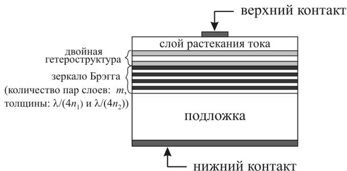
**Рис. 9.5.** Светодиод с распределенным зеркалом Брэгга, расположенным между подложкой и нижним эмиттерным слоем [2]
