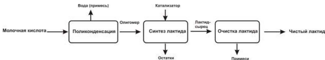
Рис.1. Схема получения лактида
