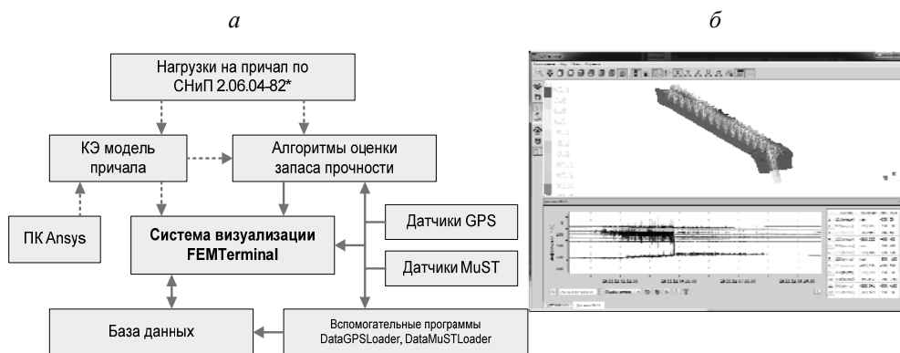
Рис. 6. Схема системы мониторинга (а); вид пользовательского интерфейса (б)
