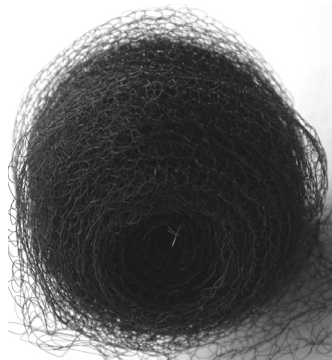
Рис. 1. Циркулярный вязаный сетчатый никелид-титановый имплантат
