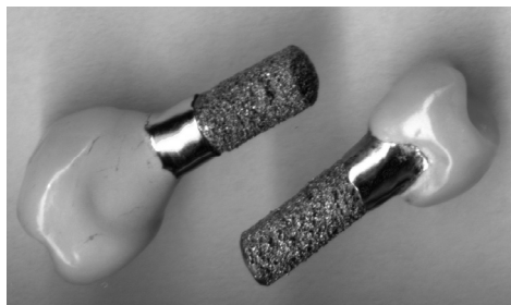
Рис. 1. Общий вид цилиндрического пористого дентального имплантата на основе никелида титана перед операцией одноэтапной имплантации
