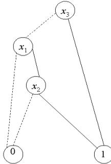
Рис. 3. Сокращённая BDD функции  $f(x_1, x_2, x_3) = x_1x_2 \vee x_3$  при начальной переменной разложения  $x_3$
