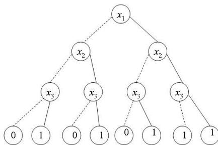
Рис. 1. BDD функции  $f(x_1, x_2, x_3) = x_1 x_2 \vee x_3$
