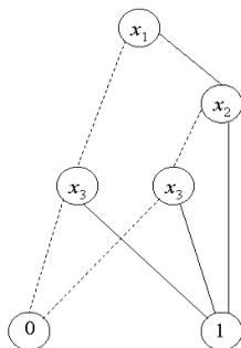
Рис. 2. Сокращенная BDD  $f(x_1, x_2, x_3) = x_1x_2 \vee x_3$
