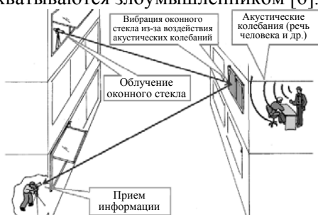
Рис. 4. Схема акустооптического канала утечки информации
