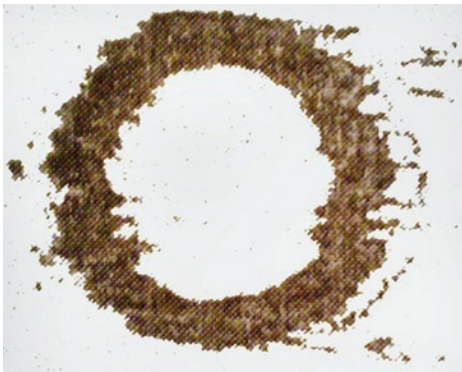
Рис.3. Кольцевая зона проскальзывания и фреттинг при контакте стального шарика с плоской поверхностью. \alpha – угол между q и t . \alpha=90^\circ .
