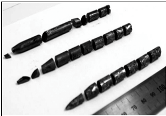
Рис. 1. Внешний вид (сверху вниз) кристаллов твердых растворов GaSe:InS (1, 5 и 20 мас. %)
