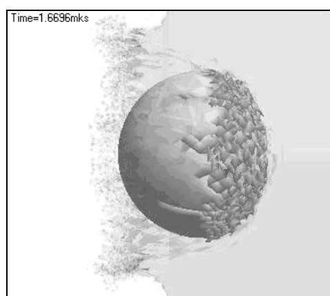
Рис. 7. Формирование меридиональной трещины
