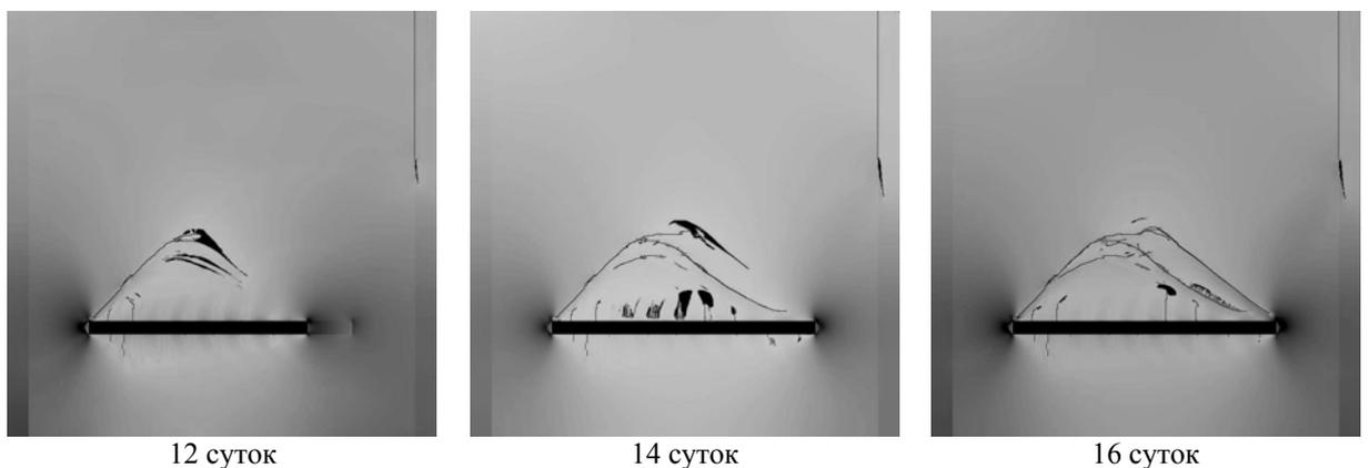
Рисунок 4 - Неравновесный режим обрушения с образованием протяженных участков зависшей кровли. Длина расчетной области 80 м, выработки – 50 м.
