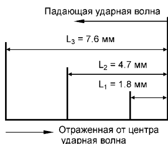
Рис. 3. Схема смены структур в меди [34]
