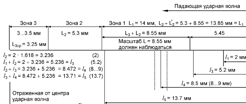
Рис. 4. Схема смены структур в сплаве алюминия [35]
