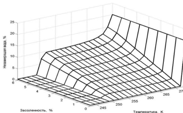
Рис. 2. Зависимость функции незамерзшей воды от температуры и засоленности
