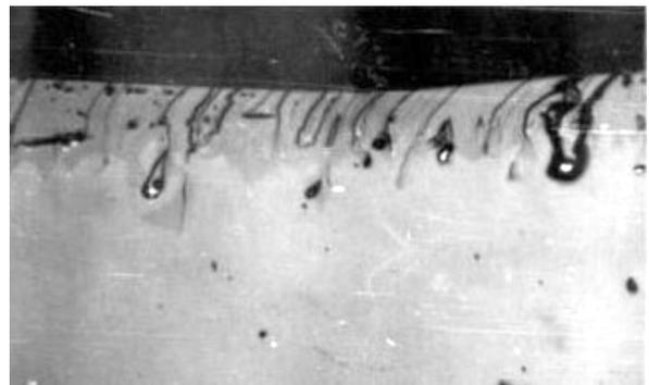
Рис. 7. Включения растворителя в гетероструктуре  $Al_xGa_{1-x}Sb/GaSb$  [35]
