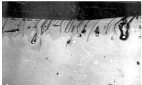
Рис. 7. Включения растворителя в гетероструктуре Al_xGa_{1-x}Sb/GaSb [35]
