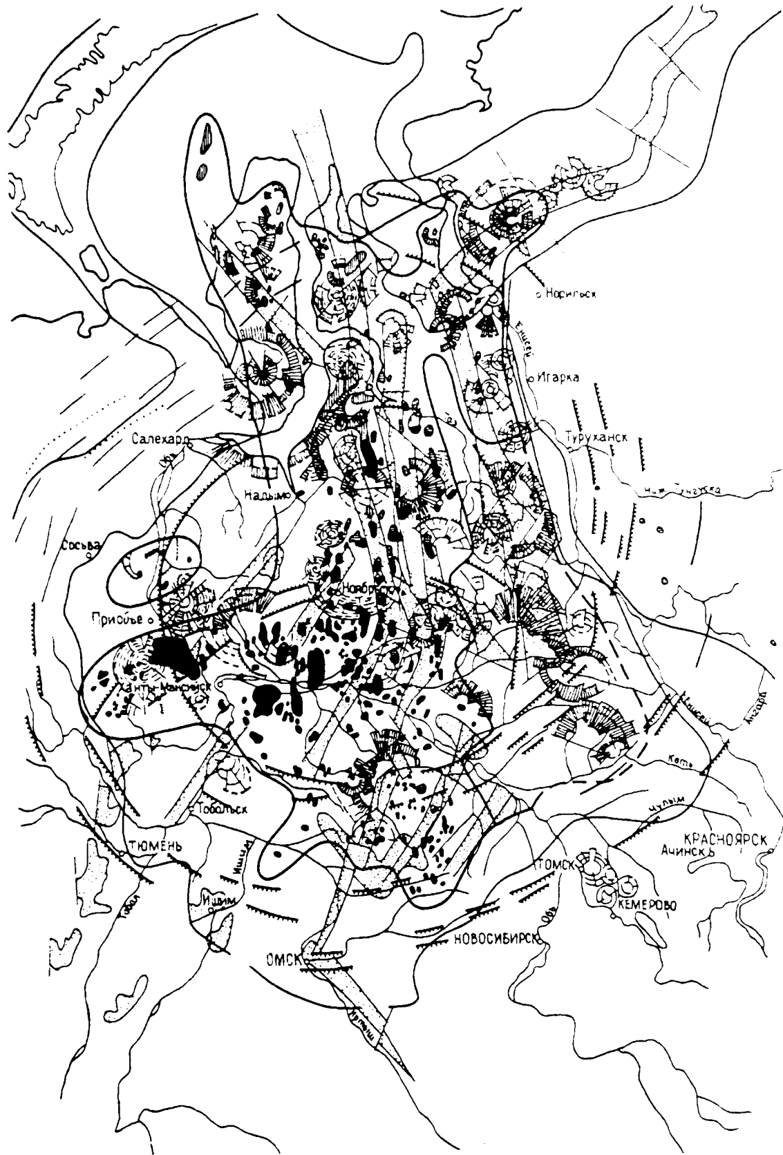
Рис. 2. Схема пространственных структурных соотношений месторождений углеводородов и морфоструктур доюрского фундамента Западно-Сибирской плиты.
