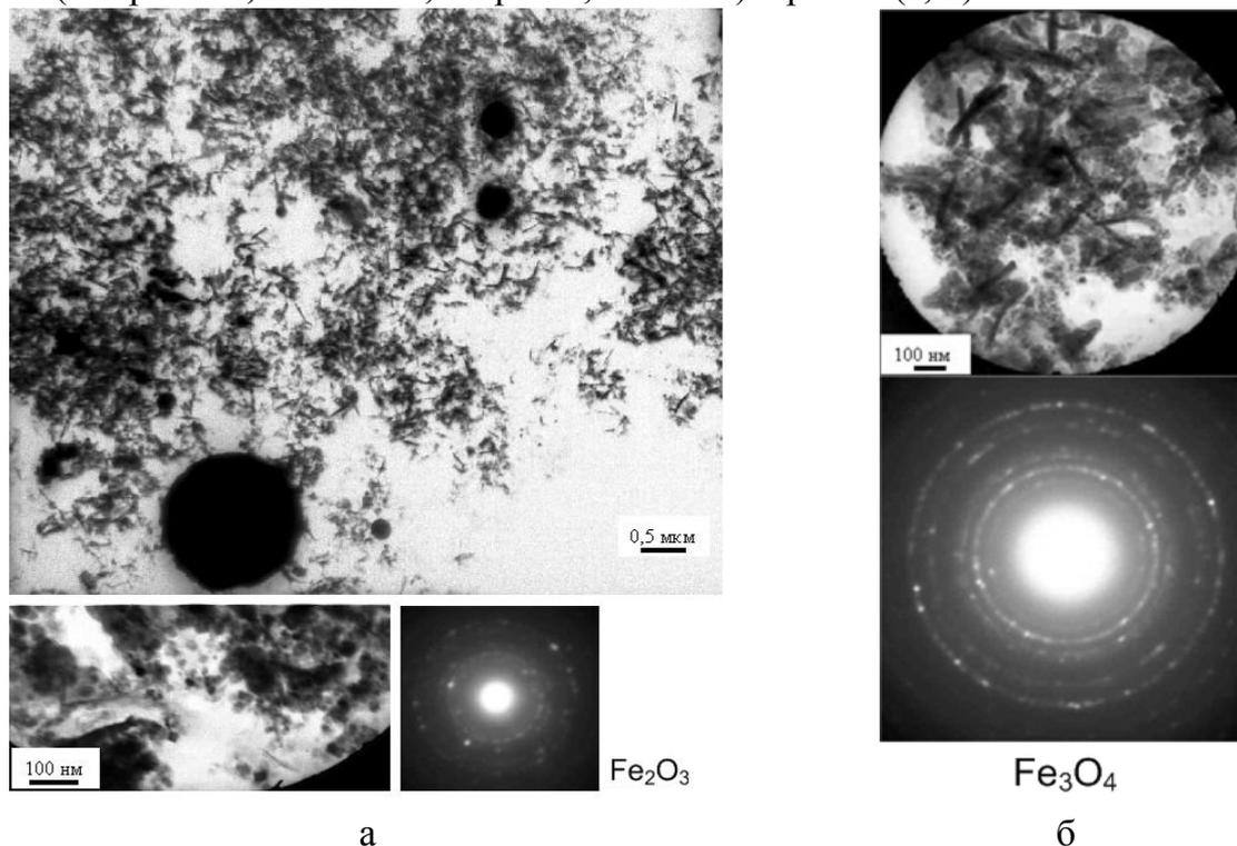
Рис. 2. Электронно-микроскопическое изображение (а) – частиц Fe<sub>2</sub>O<sub>3</sub>; (б) – Fe<sub>3</sub>O<sub>4</sub> в образце, полученном в результате обработки железной стружки ИЭР в щелочной среде (рН=11) с предварительной отдувкой аргоном в течение 18 часов. Время действия ИЭР 10 мин.
