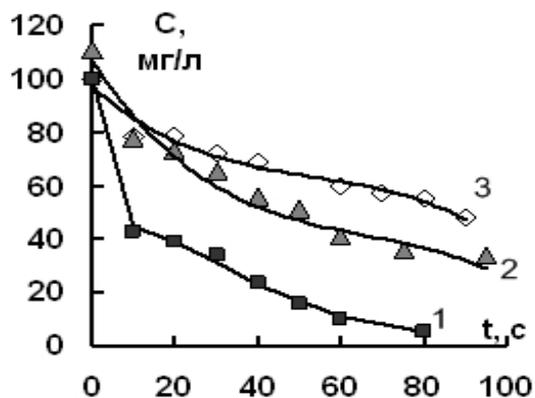
Рис. 4. Изменение концентрации катионов, мг/л (1) –  $Ni^{2+}$  и (2) –  $Mn^{2+}$ , (объем раствора 100 мл), (3) –  $Ni^{2+}$  (объем раствора 600 мл) от времени обработки ИЭР, с.  $C_0(Ni^{2+})=100$  мг/л;  $C_0(Mn^{2+})=110$  мг/л.
