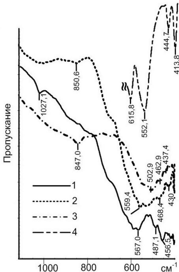
Рис. 7. ИК – спектры образцов, полученных в результате действия ИЭР в реакторе с железными гранулами: (1) – в  $\text{H}_2\text{O}$  (2) в растворе, содержащем ионы  $\text{Cr}_2\text{O}_7^{2-}$ ; (3) и (4) – спектры  $\text{Cr}(\text{OH})_3$  и  $\text{Cr}_2\text{O}_3$  полученных химическим путем
