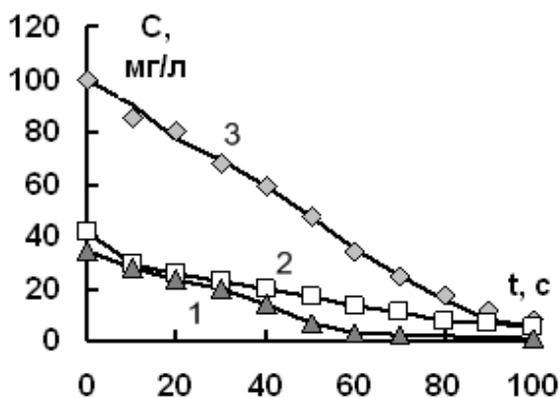
Рис. 3. Изменение концентрации анионов, мг/л (1) –  $H_2AsO_4^-$ , (2) –  $Cr_2O_7^{2-}$ , (3) –  $HSiO_3^-$  от времени обработки ИЭР, с. Объем раствора 600 мл.  $C_0(As^{5+})=36,5$  мг/л;  $C_0(Si^{4+})=100$  мг/л;  $C_0(Cr^{6+})=41,5$  мг/л.
