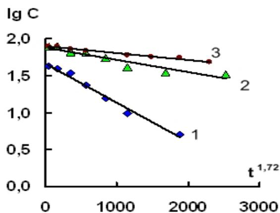
Рис. 5б. Зависимость  $\lg C - t^{1,72}$  при действии ИЭР на железные гранулы в растворе соли, содержащей катионы (1) –  $\text{Ni}^{2+}$  и (2) –  $\text{Mn}^{2+}$ , (объем раствора 100 мл), (3) –  $\text{Ni}^{2+}$  (объем раствора 600 мл)
