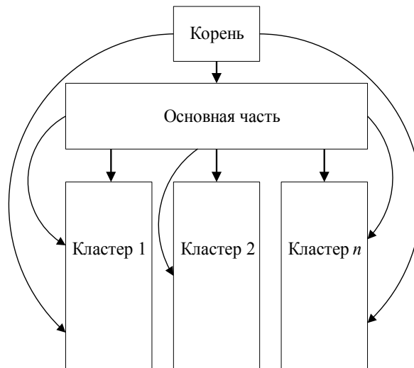
Рис. 3. Структура кластерной мультитриангуляции (К-МТ)
