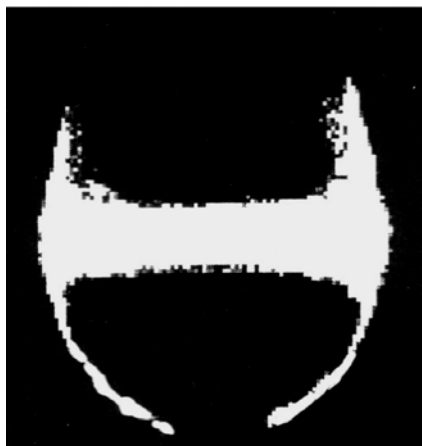
Рис. 1. Фотография светящейся миллиметровой капли с Р6Ж при продольной накачке сфокусированным лазерным пучком ( \lambda=532 нм, \tau=10 нс)
