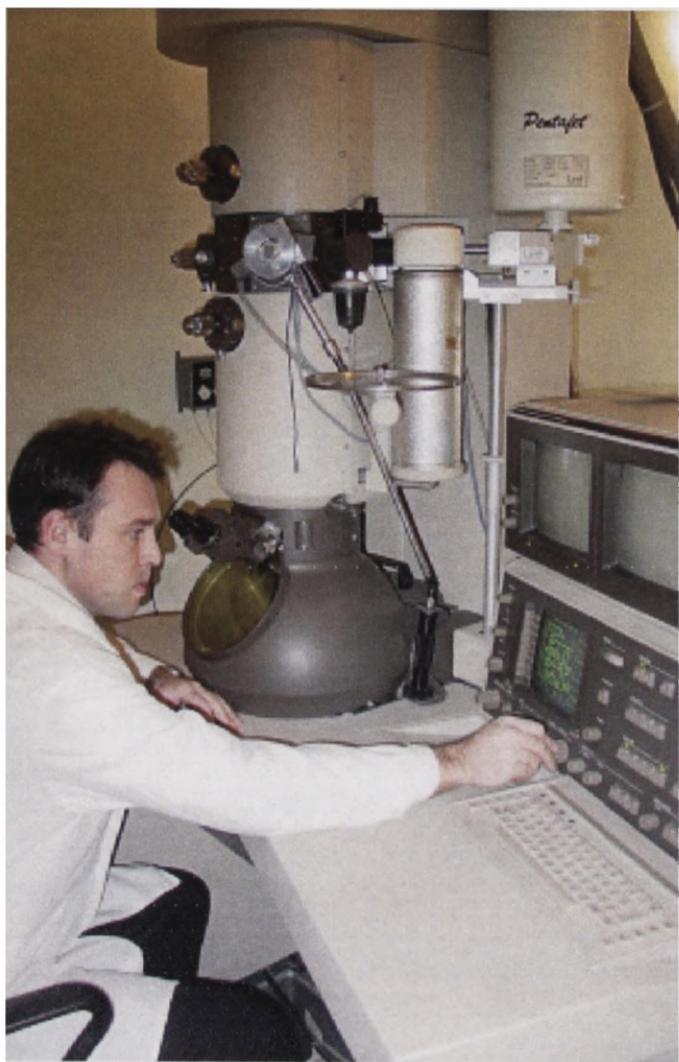
**Просвечивающий электронный микроскоп Philips CM 30.
