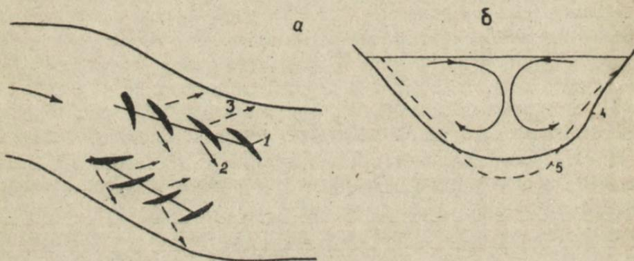
Рис. 75. Схема расположения и работы щитов Потапова над перекатом ( а - план; б - поперечное сечение русла):
