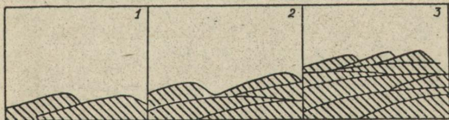
Рис. 45. Схема возникновения диагональной слоистости в русловом аллювии при движении песчаных волн по дну реки ( по Шанцеру Е.В., 1951)
