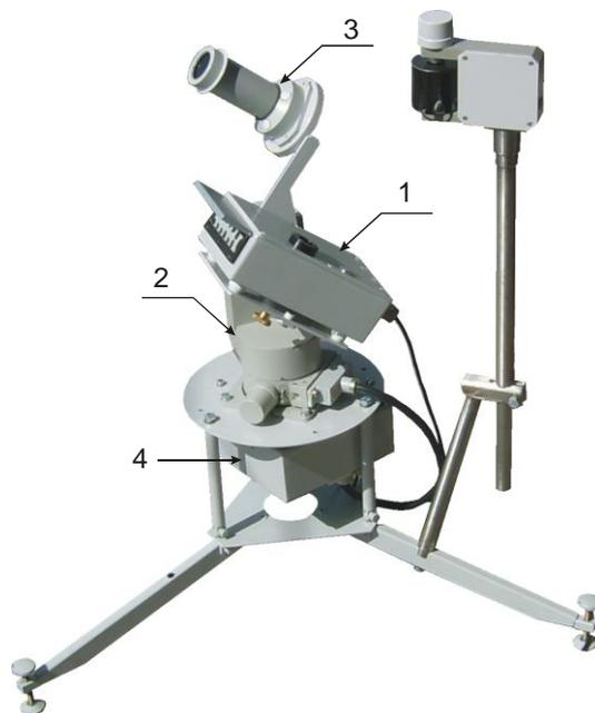
Рисунок 6 – Внешний вид фотометра SP-9 с системой наведения-слежения за Солнцем (1 – фотометр, 2 – устройство наведения, 3 – блок координатных датчиков, 4 – блок управления)
