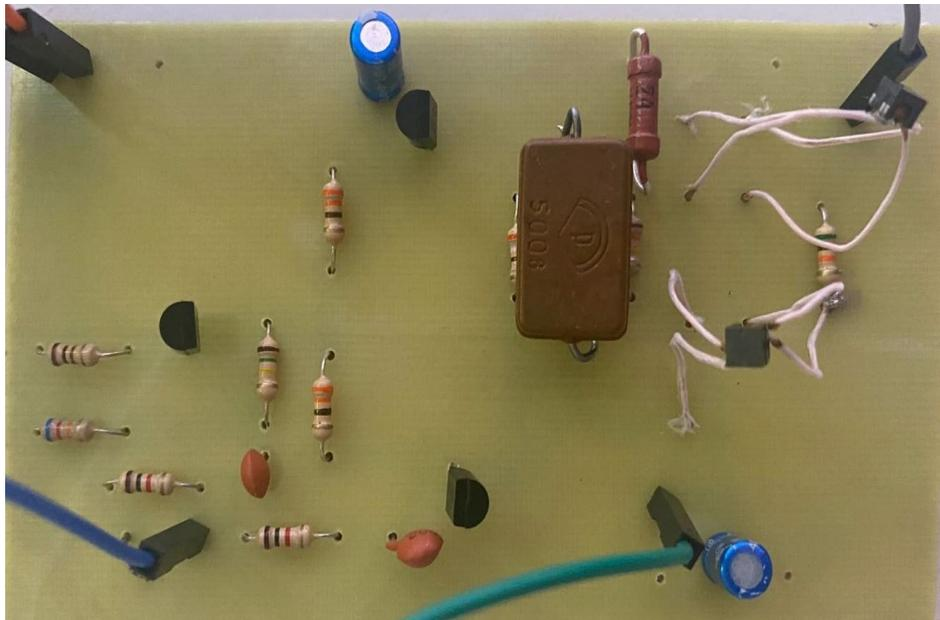
Рисунок 28 – Печатная плата преобразователя частоты
