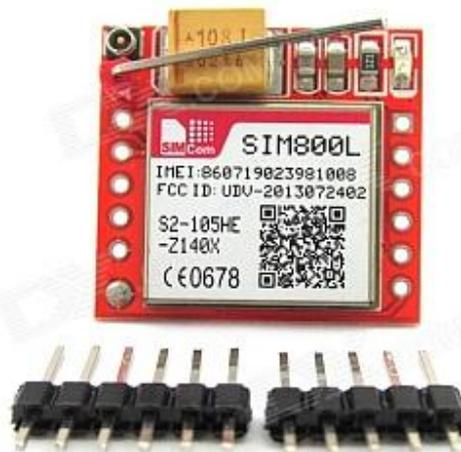
Рисунок 19 – Модуль GSM на чипе SIM800L [8]
