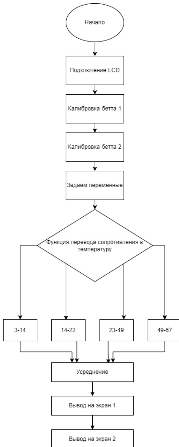
Рисунок 42 – Алгоритм программы на Arduino
