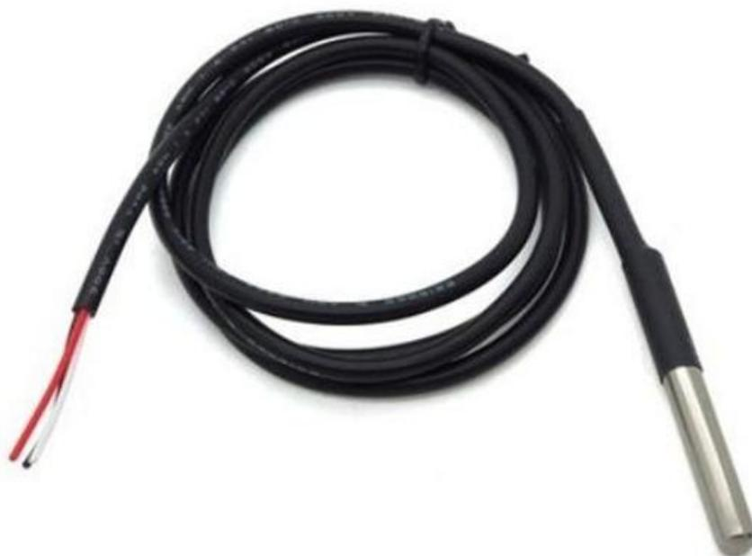
Рисунок 11 – Цифровой датчик DS18B20 [6]
