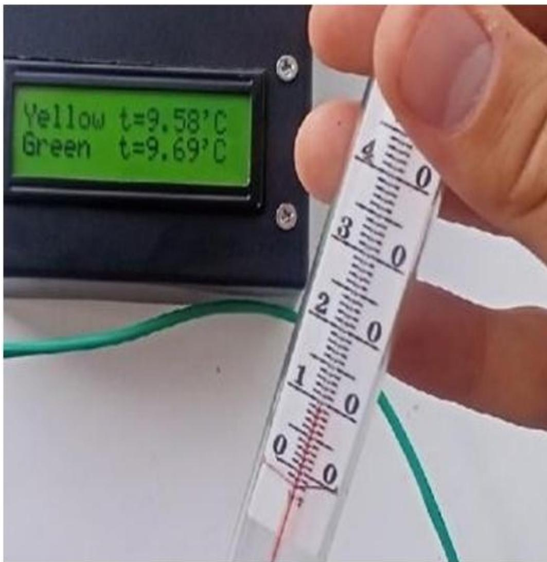
Рисунок 46 – При температуре 9,5 °С, погрешность измерений составляет 0,1 – 0,2 °С
