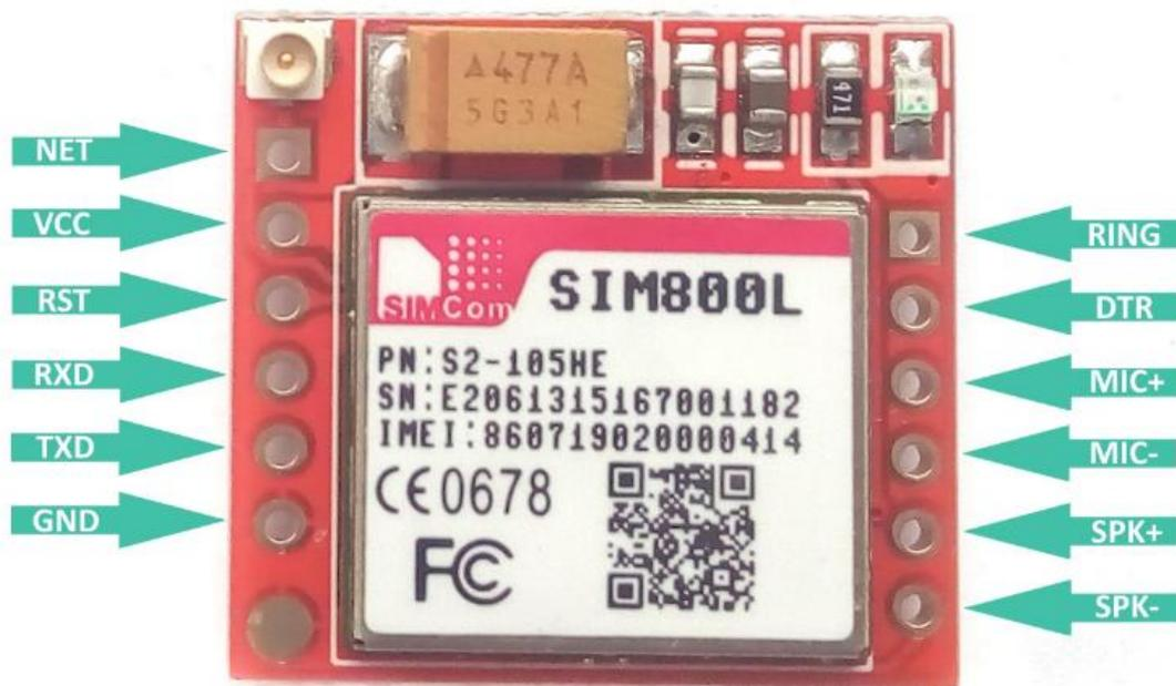
Рисунок 21 – Расположение контактов на модуле GSM на чипе SIM800L
