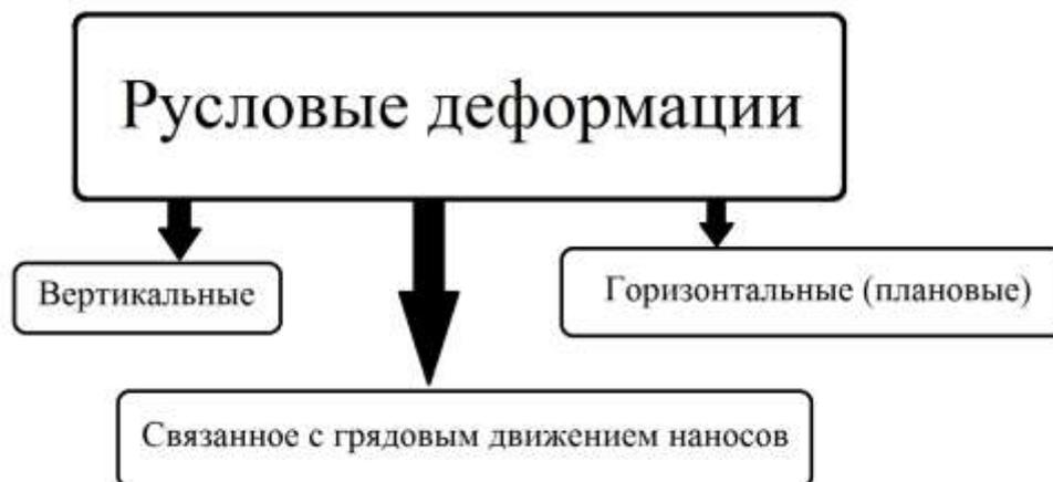
Рисунок 1 – Схема классификации русловых деформаций относительно направления силы тяжести (по Р.С. Чалову, 1979) (составлена автором)
