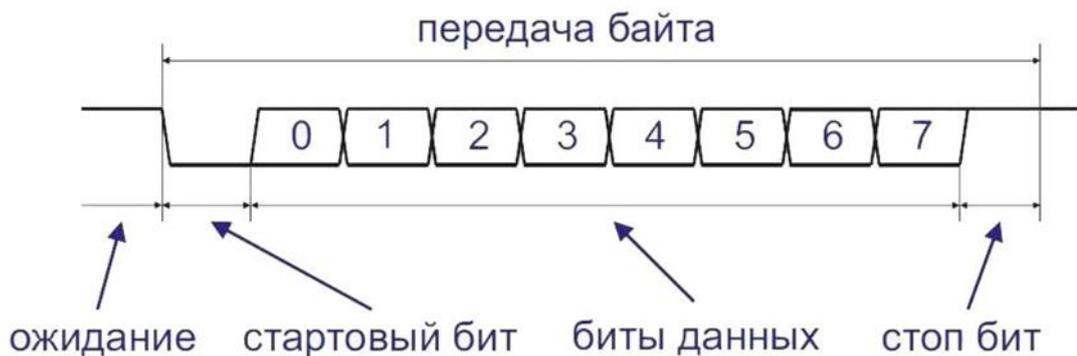
Рисунок 16 – Структура передачи информации
