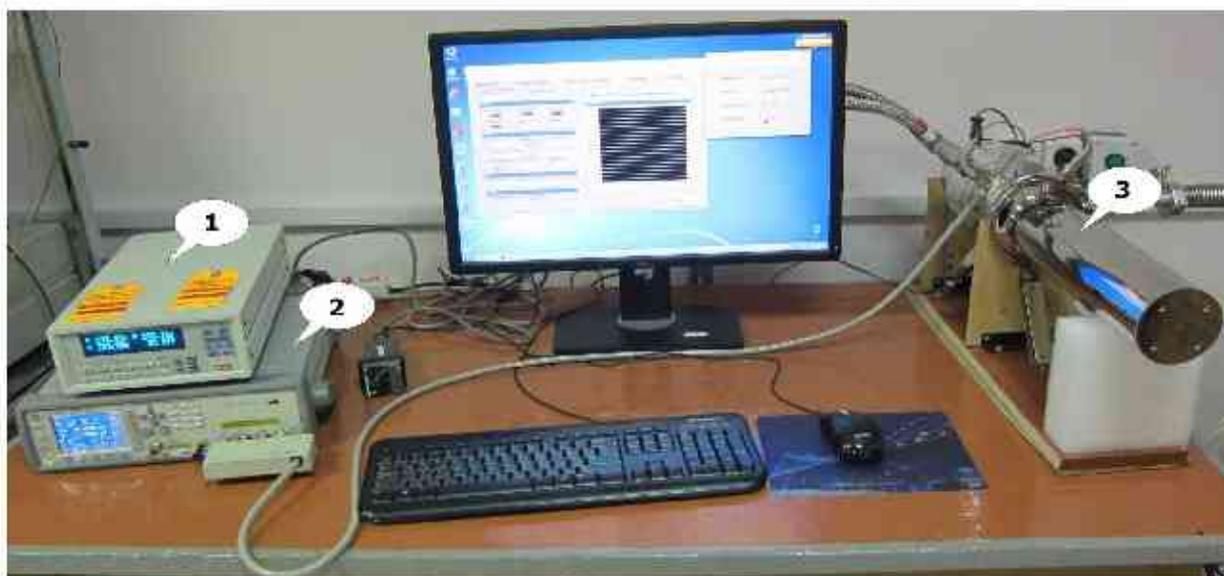
Рисунок 2.1 - Внешний вид автоматизированной экспериментальной установки. 1. контроллер температуры LakeShore 335, 2. LCR-измеритель Agilent E4980A, 3. Неоптический гелиевый криостат замкнутого цикла Janis CCS-400/204
