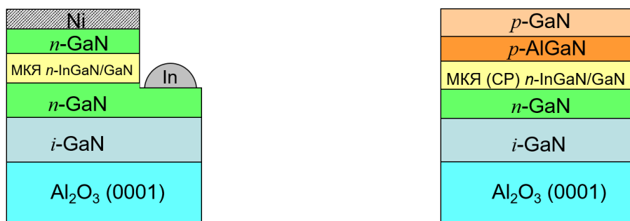
Рисунок 1 – Схематические изображения монополярной (а) и светодиодной (б) структур с активной областью на основе множественных квантовых ям InGaN/GaN
